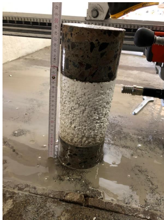
Figur 5 – Visar hur väggkonstruktionen ser ut med sina tre lager av betong och cellplast. Bilden är från Johannas stadsodlingar
